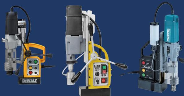
Base magnética, base de taladro, y la máquina de perforación en un paquete que permite un ajuste fácil.
