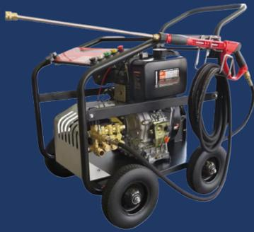
Hidro lavadora a diésel, equipada con motor de 10.5 hp y bomba de alta presión de tipo triplex, presión máxima de 3600 psi y un caudal máximo de 15 l/min. Las hidro lavadoras Toyama poseen fácil manejo y utilización ya que brindan regulación de presión y ruedas. Fueron formuladas para trabajos constantes. Son equipadas con ruedas, para la mayor movilidad y facilidad en la operación.
