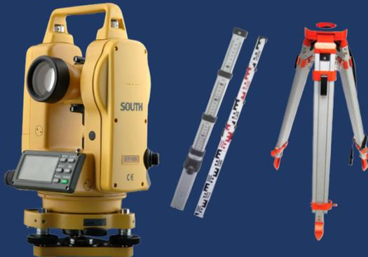
Taquímetro electrónico marca SOUTH modelo ET05 con teclado y pantalla de cristal líquido iluminable en ambos lados, lectura electrónica de ángulos con precisión de 2" Y 5 " con aproximación a 1". Teodolito Digital South ET posee compensador vertical. Con su batería de larga duración podrá trabajar hasta 10 horas de manera continua. Posee funciones básicas como configurar cero, ingresar un azimut, lectura de pendientes, retener ángulos, lectura de ángulos a la derecha o a la izquierda
