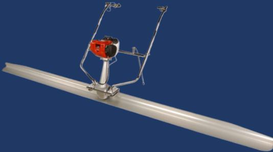
Nuestra regla vibratoria es un equipo liviano y portátil, el cual no necesita trabajar sobre moldes o guías para ejecutar un trabajo perfecto. Tres etapas de trabajo en 1 solo paso: compactar, enrasar y nivelar. Es muy fácil de operar y transportar, está equipada con el confiable moto. La SCE5008 se compone de la unidad motriz y cuatro opciones de reglas según el trabajo que se necesite realizar.
