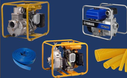
Motobomba a gasolina semi profesional 2" x 2" centrífuga. Fiable, eficiente y robusta. Diseñada para proveer de agua donde usted lo necesite. Equipos de fácil mantenimiento y bajo consumo de combustible. Motor con sensor de aceite.
